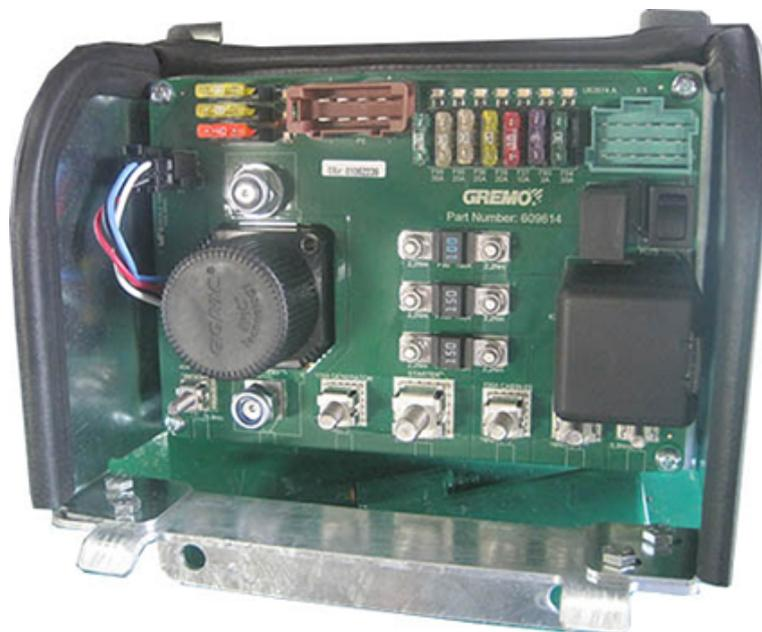
Bild 137 Sicherungsliste: rechter Motorraum
