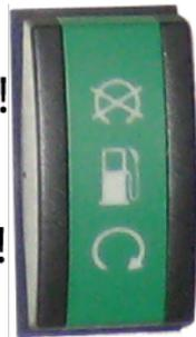
Bild 121 Starten der Kraftstoffpumpe
