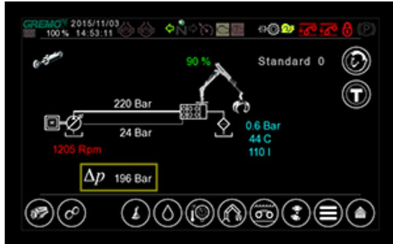
Bild 58 GreControl, Hydraulikfenster
