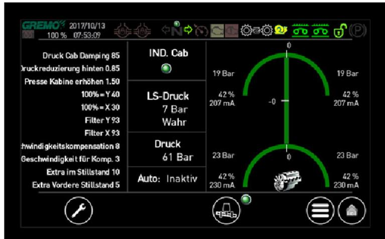
Bild 65 GreControl, Einstellungen zur Kabinenaufhängung
