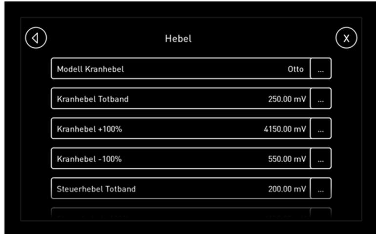
Bild 61 GreControl, Hebeleinstellungen
