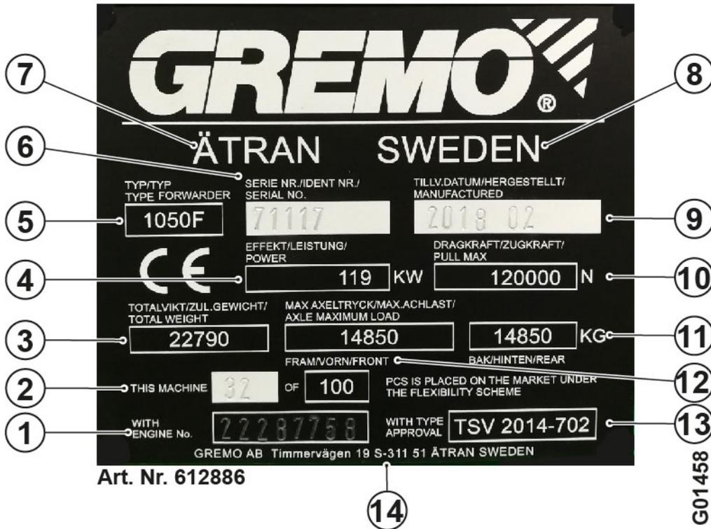
Bild 4 Typenschild für die Maschine
