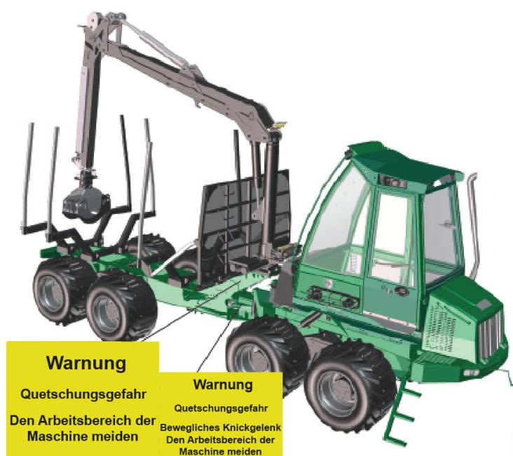
Bild 27 Folgende Warnschilder für Quetschverletzungen befinden sich an der rechten und linken Seite der Maschine:
