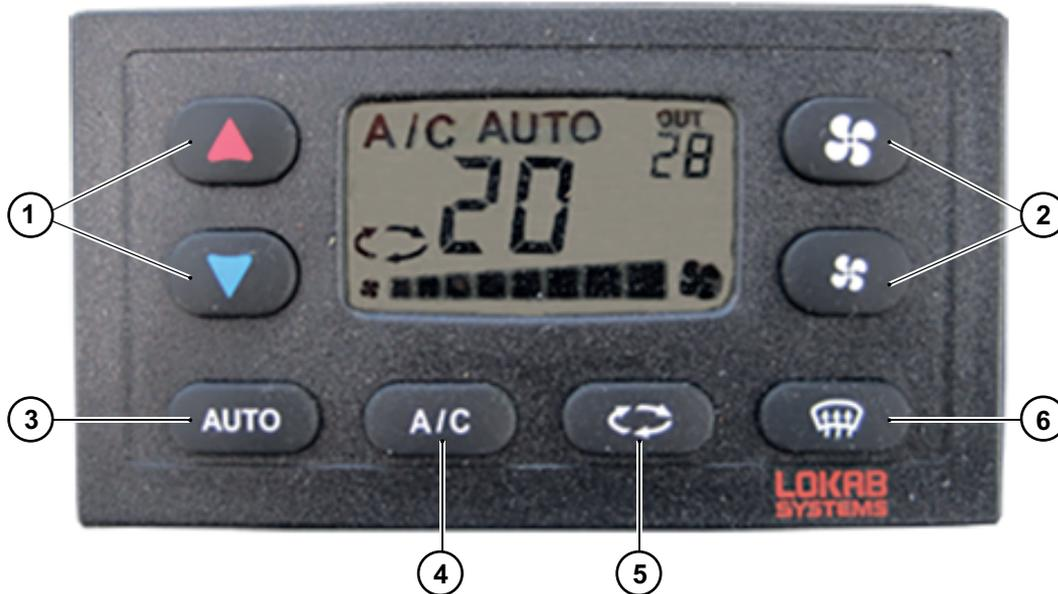
Bild 48 Bedienfeld für die Klimaanlage
