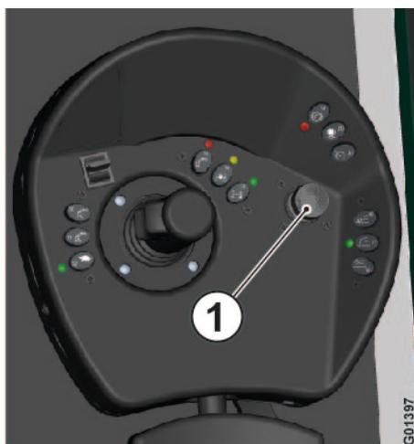
Bild 99 Geländelenkung
