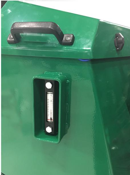
Bild 141 Füllstandsprüfung
