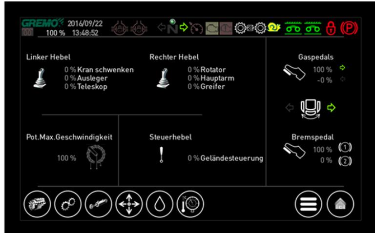
Bild 59 GreControl, Hebelfenster
