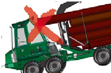
Bild 112 Beladen über die Höhe des Gitters
