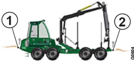
Bild 39 Zugösen der Maschine
