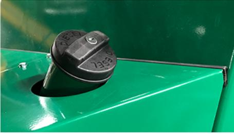
Bild 122 Kraftstoffeinfüllleitung
