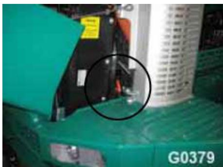
Bild 90 Motoröl-Messstab
