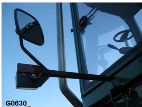
Bild 114 Richtungsanzeiger und Rückspiegel
