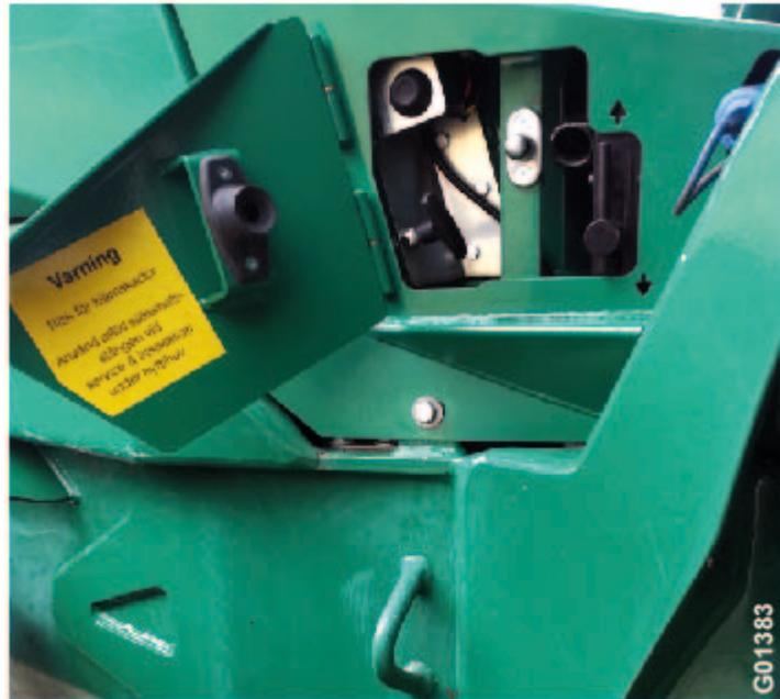
*Bild 30 Schutzabdeckung zur Kontrolle der Kabinenneigung*
