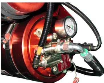
Bild 149 Feuerlöschsystem, Sicherheitsschraube
