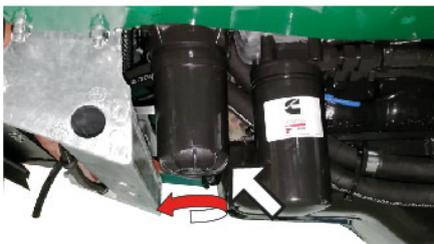
Bild 16 Ausbau der Kraftstofffilter
