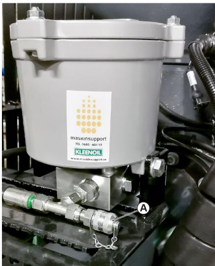
Bild 30 Der Auslass befindet sich neben dem Nebenstromfilter des Hydrauliksystems.
