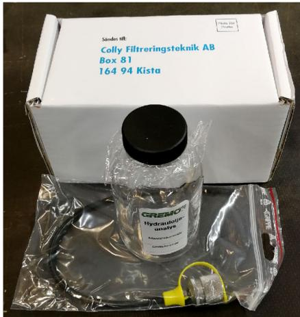
Bild 29 Probenahmepaket für Hydrauliköl
