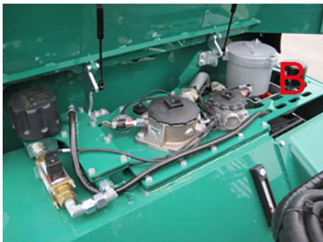
Bild 33 Wechsel des NebenstromfILTERs, Hydrauliköl
