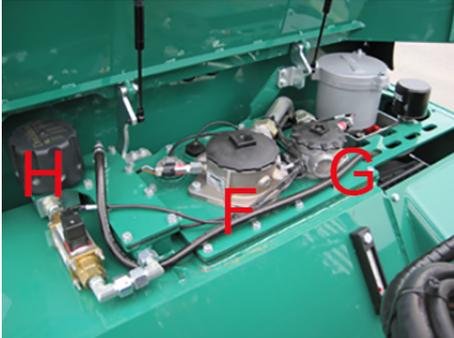
Bild 32 EntlüftungsfILTER (H)
