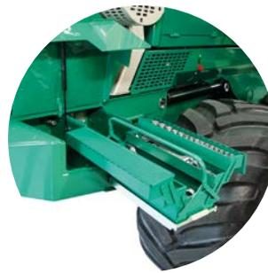
Compartiment rangement/outils chauffant (zone avant gauche du châssis)
